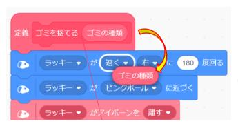
定義「ゴミを捨てる」で渡された 引数を次からのブロックで使える ようにするために、「ゴミの種 類」をマウスで操作すると動かす ことができます。
